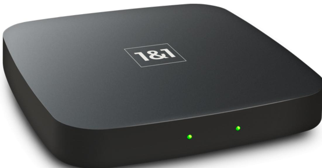
Zur Herstellung der WLAN-Verbindung drücken Sie einfach die WPS-Taste (Wi-Fi Protected Setup) auf Ihrem Router. Sollte Ihr [1&1 HomeServer](#) keinen WPS-Button haben, drücken Sie die WLAN-Taste so lange, bis sie blinkt. Anschließend wird das Gerät automatisch mit dem WLAN verbunden.
